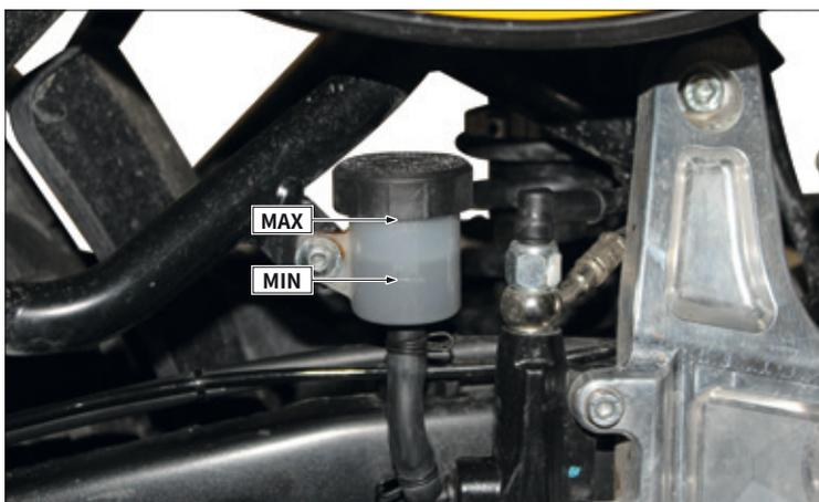
**9.5 CHECK THE REAR BRAKE MASTER CYLINDER OIL LEVEL**
