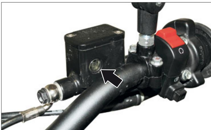
**9.4 CHECK THE FRONT BRAKE MASTER CYLINDER OIL LEVEL**
