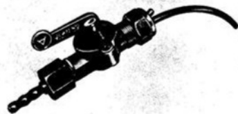
11 K Kraftstoffhahn vor dem Einbau
