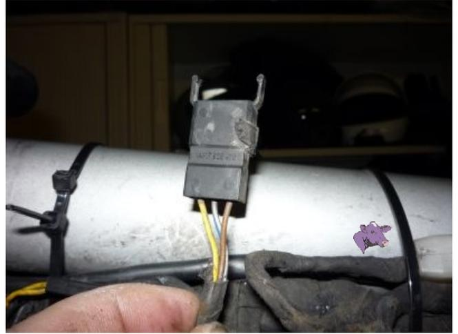
Das war schon der der ganze Umbau des Blinkrelais auf Warnblinkfunktion. Die Platine kann jetzt wieder in das Gehäuse geschoben werden, der Deckel montiert und mit handelsüblichem Silikon versiegelt werden. Dann rein mit dem Relais an seinen ursprünglichen Platz.
