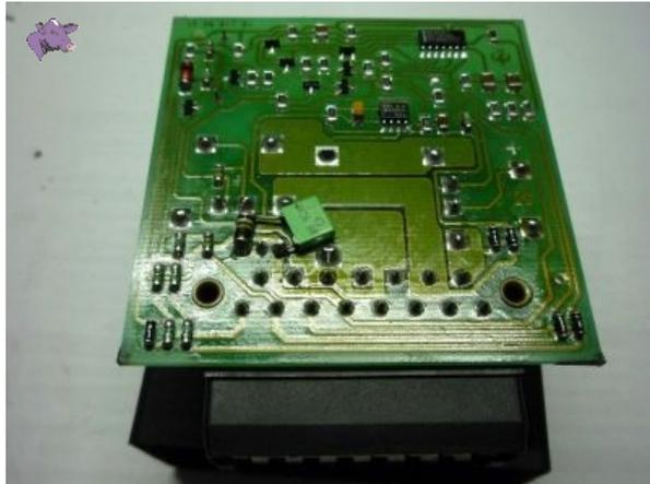
Auf der Unterseite wimmelt es von Bauteilen, dort ist die ganze Elektronik in SMD Technik untergebracht. Die Bauteile brauchen uns für unser Vorhaben nicht zu interessieren. Das grüne rechteckige Bauteil das frei aufgelötet ist, ist übrigens serienmäßig. Wahrscheinlich ein kleiner Layoutfehler bei der Entwicklung. Am unteren Rand der Platine erkennen wir die 15 Lötunkte der Steckerleiste, die sind für die Nachrüstung der Warnblinkfunktion interessant.
