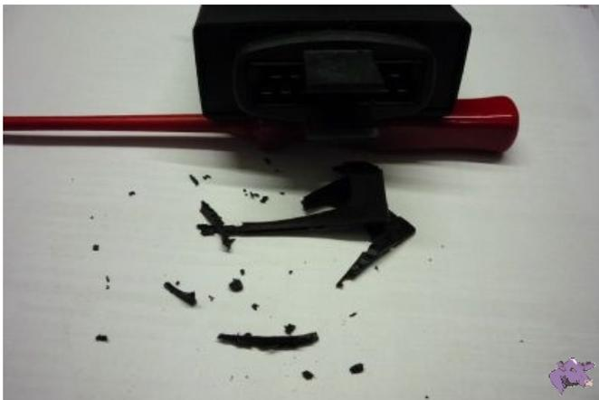
Diese dünne Schicht Dichtmasse wird mit einem Schraubenzieher entfernt und der Deckel anschließend vorsichtig aus den Haltenasen herausgehoben. Aber bitte wirklich vorsichtig, das Gehäuse ist schnell eingerissen.
