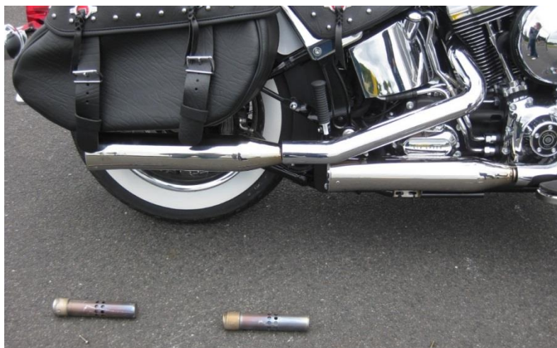
Abbildung 11: Ersatzschalldämpferanlage mit ausgebauten „dB-Eatern“
