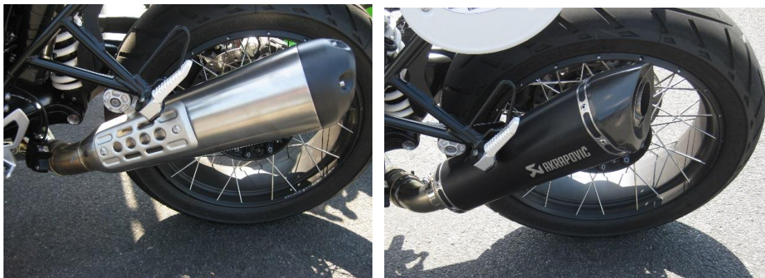
Abbildung 14: Original- und Ersatzschalldämpferanlage der BMW-Maschine
