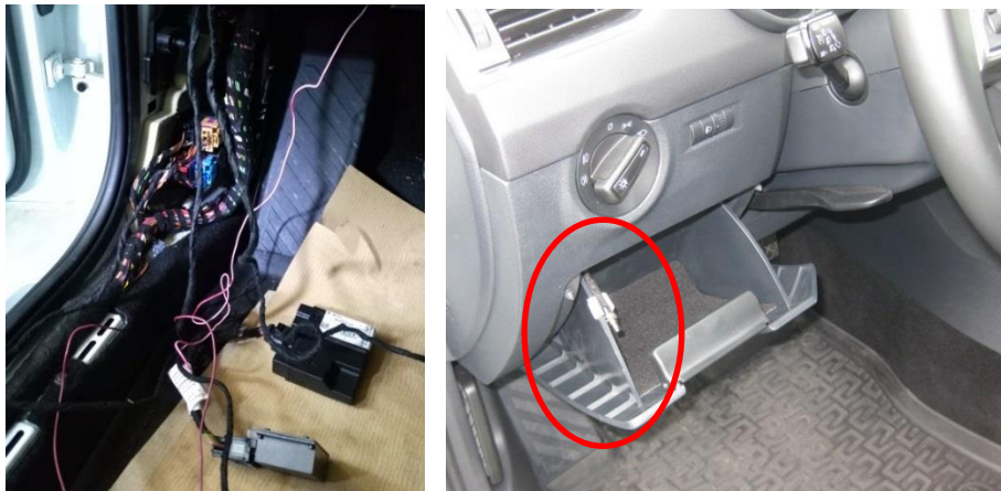
Abbildung 25: Verkabelung der Steuereinheit
