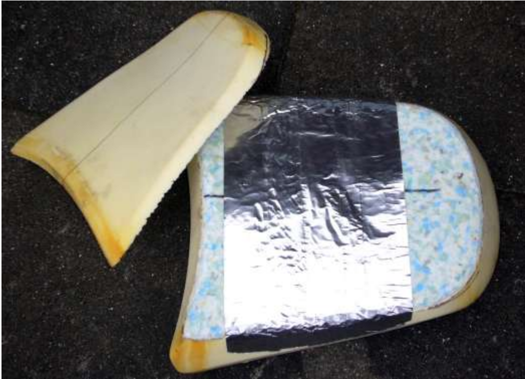
Soziussitz mit aufgeklebtem 10mm Formschaum und Alufolie. Der Schaumstoff-Deckel links oben ist die entfernte Schicht des Original-Sitzschaums; vorne 10mm – hinten 25mm.
