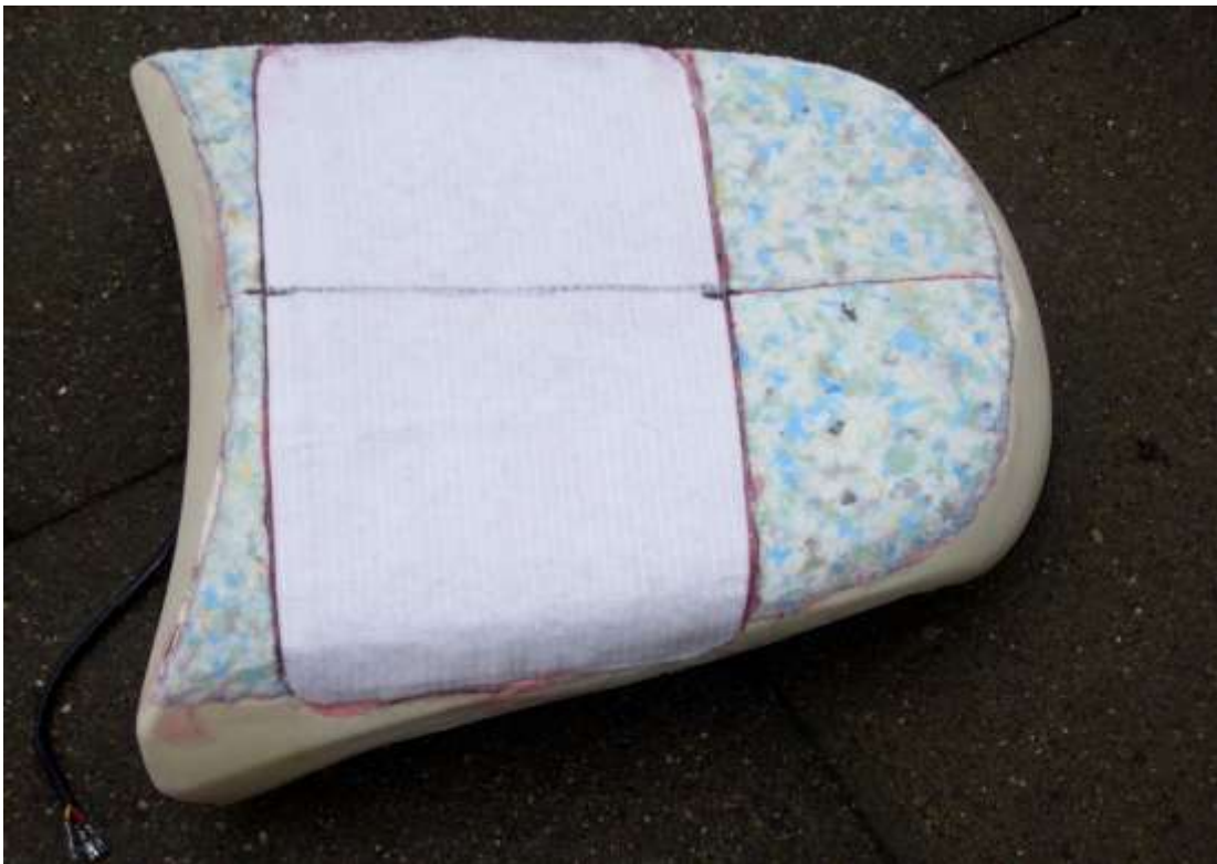
Bei einer späteren Version habe ich die Alufolie und Heizmatte 3mm tief in den Verbundschaum eingelassen, so dass es eine ebene Oberfläche gibt.
