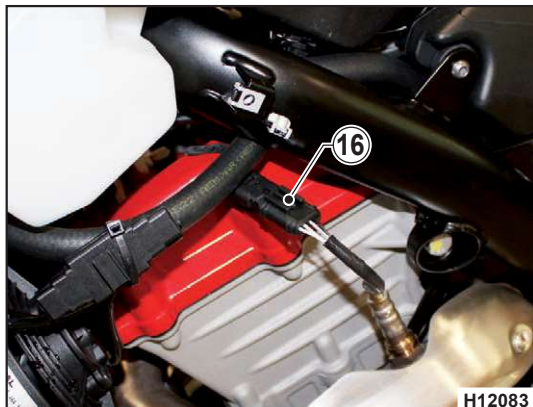
16) Lambda sensor connector.
