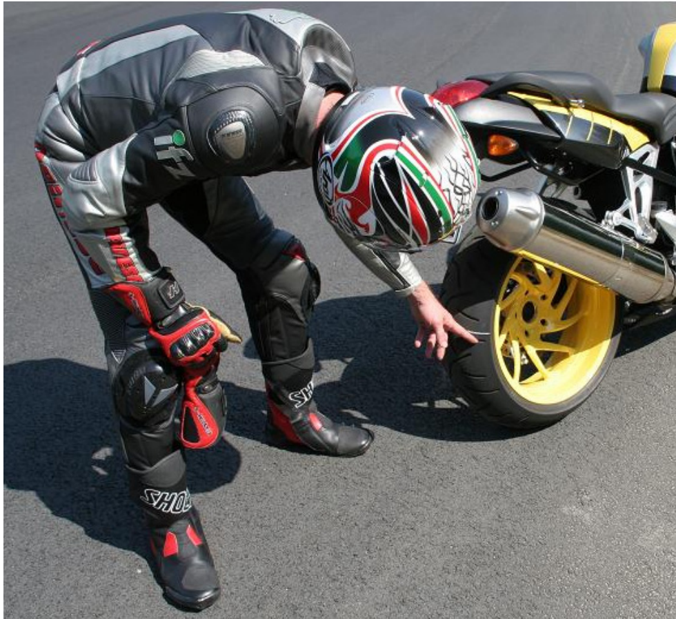
Abbildung 7: Ein Kreidestrich quer über die Reifenlauf­fläche gibt Auskunft über die gefahrene Schräglage
