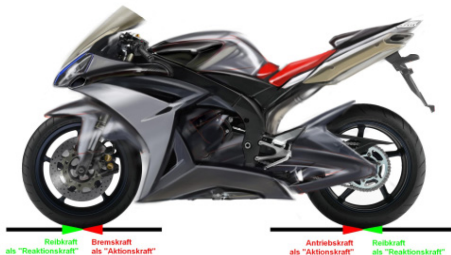
Abbildung 2: Reibkräfte als Reaktionskräfte aufgrund von Aktionskräften (Grafik: Yamaha Motor Deutschland)
