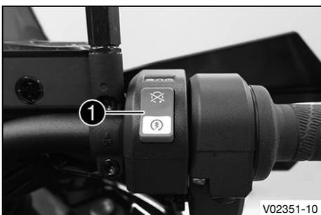
Die/Der Starttaste/Not-Aus-Schalter **1** ist am Kombischalter rechts angebracht.
