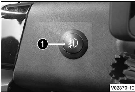
Der Zusatzscheinwerfer-Schalter **1** ist links neben dem Kombiinstrument angebracht.
