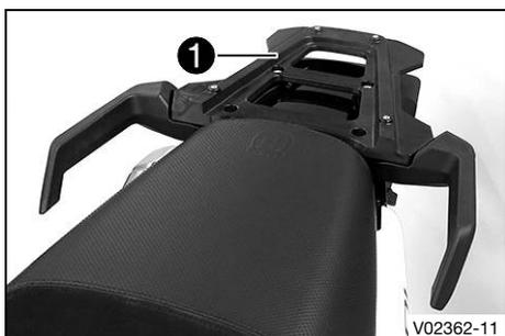
Die Gepäckträgerplatte ❶ befindet sich hinter der Sitzbank. An der Gepäckträgerplatte kann die Grundplatte eines Koffersystems (optional) befestigt werden. Die Gepäckträgerplatte darf maximal mit dem angegebenen Gewicht belastet werden.
