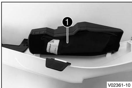
Im Staufach links oder im Staufach rechts befindet sich das Bordwerkzeug ❶.
