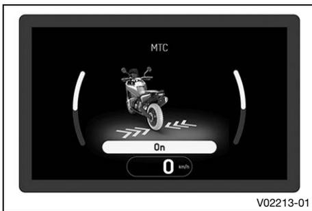
Die Motorrad-Traktionskontrolle (**MTC**) verringert das Motor-drehmoment bei Traktionsverlust am Hinterrad. Abhängig vom **Fahrmodus** wird bei aktivierter Traktionskontrolle unterschiedlich viel Schlupf zugelassen.
