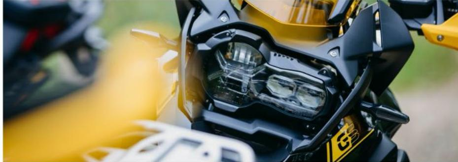
Schwenkfunktion. Mit der Sonderausstattung „Adaptives Kurvenlicht“ wird das Abblendlicht des serienmäßigen Voll-LED-Scheinwerfers abhängig von der Schräglage in die Kurve hineingedreht. Auf diese Weise werden Kurven nahezu voll ausgeleuchtet, weil sich das Licht dort befindet, wohin sich das Motorrad bewegt.
