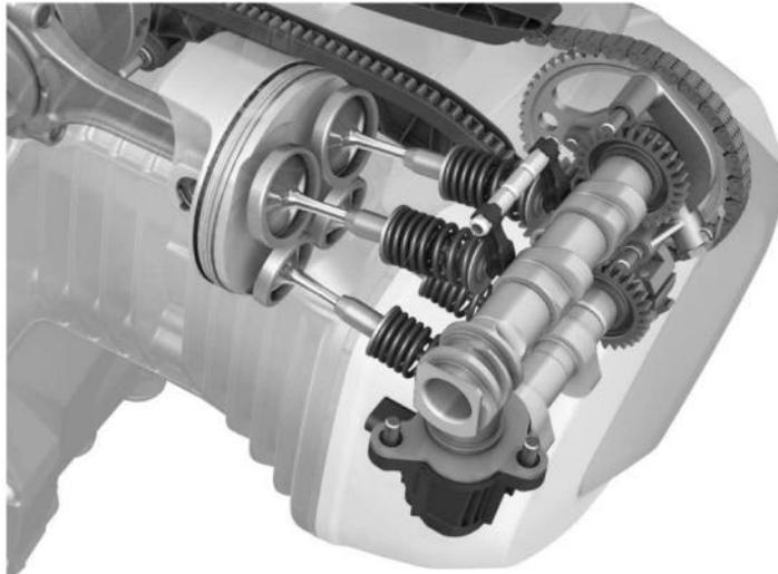
Über eine axiale Verschiebung der Einlassnockenwelle werden die Einlassventile last- und drehzahlabhängig entweder von der Teillast- oder der Volllastnocke betätigt. Die axiale Verschiebung der Einlassnockenwelle und damit der Einsatz von Teillast- oder Volllastnocke erfolgt über eine Schaltkulisse auf der Nockenwelle und einen dort im Eingriff befindlichen elektromechanischen Aktuator.
