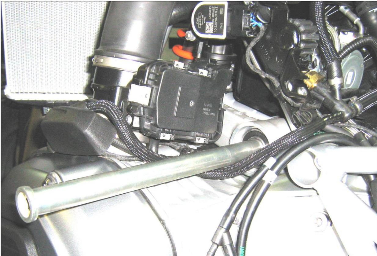
Um den nötigen Platz zum Aus- bzw. Einbau des Telelever-Federbeins zu erreichen, muss der Telelever-Schenkel gleichzeitig nach vorne und unten geschoben werden. Die Achsschraube muss anschließend mit 120 Nm angezogen werden.
