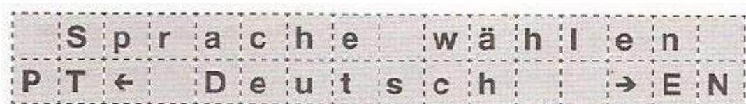
**Sprache einstellen:** Drücken Sie die Taste F1 ca. 1 Sekunde lang. Das Sprachmenü erscheint. In der Mitte des Displays wird die gewählte Sprache angezeigt, links und rechts die Sprachoptionen zum Umstellen. Die ausgewählte Sprache muss mit der Taste OK bestätigt werden. Verfahren Sie für die anderen verfügbaren Sprachen in gleicher Weise. Hinweis: Das Sprachmenü kann nur aufgerufen
