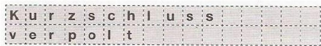
**Die Anzeige erscheint**, wenn sich die abgeklemmten Ladezangen berühren oder die Batterie verpolt angeschlossen ist (Plus- und Minus-Klemme des Ladeadapters sind vertauscht). Entfernen Sie den Kurzschluss an den Ladezangen oder schließen diese richtig gepolt an.
