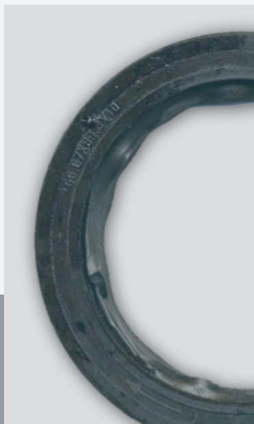
▲ Beschädigte PTFE-Dichtlippe als Ausfallursache.
