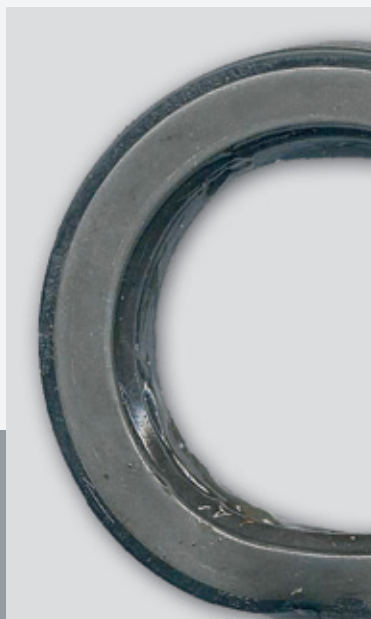
▲ Gefettete PTFE-Dichtlippe als Ausfallursache.
