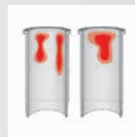
Glanzstellen im oberen Laufflächenbereich
