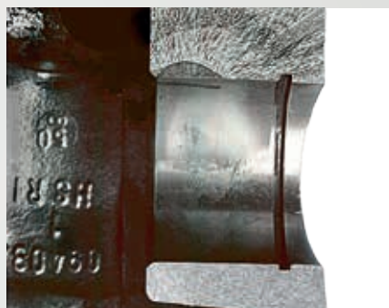
Abb. 3 Querschnitt einer Kolbenbolzennabe
