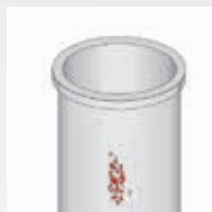
Kavitation an Zylinderlaufbuchsen
