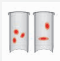
Ungleichmäßiger Laufflächenverschleiß
