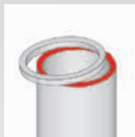
Abgerissener Buchsenbund an der Zylinderlaufbuchse
