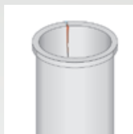
Längsrisse in der Zylinderlaufbuchse
