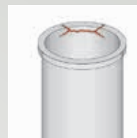
Zylinderlaufbuchsenriss durch Flüssigkeitsschlag
