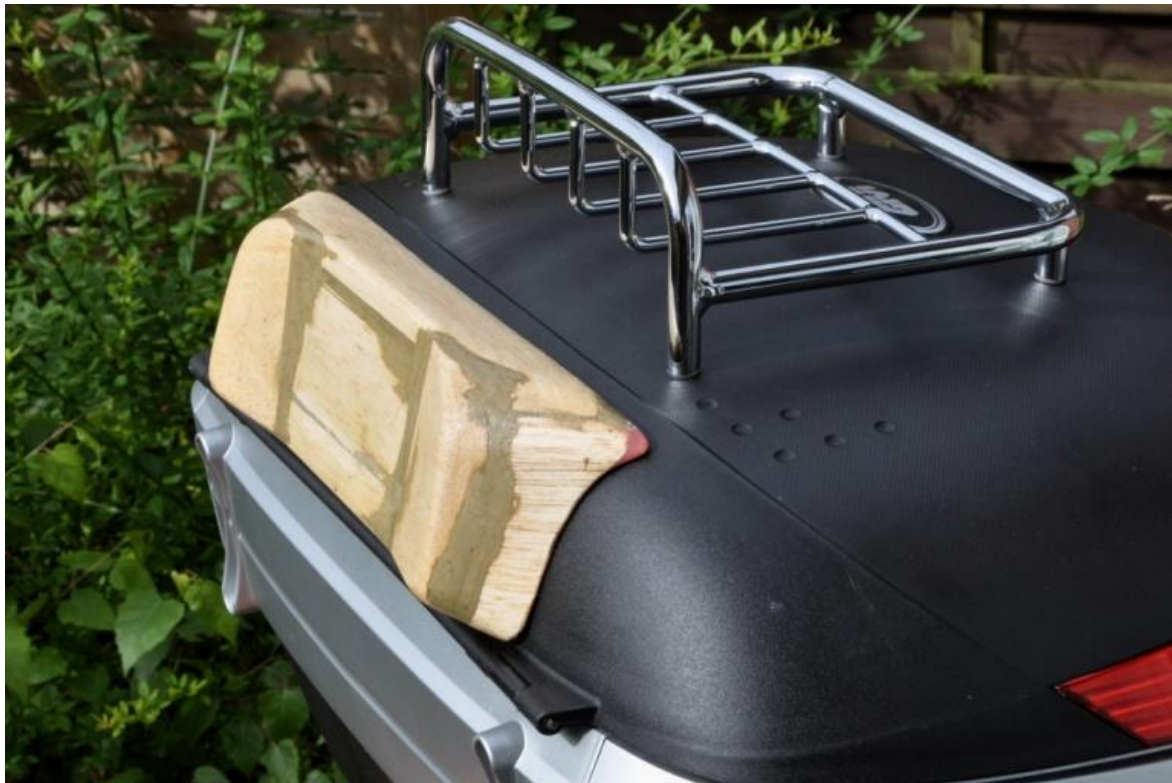
Hier der fertige Rückenlehnen-Unterbau, gespachtelt und mit Epoxidharz oberflächenbehandelt.
